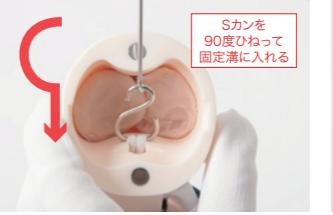
Sカンが固定溝に入るよう90度にひねって、引き上げたSカンを下ろして固定します。
