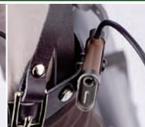
ワイヤー射出装置内側の金具を、ハーネスの腰ベルトに差し込んで固定する。
