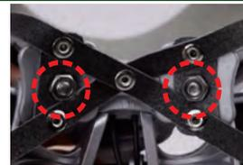
ナットを手で締めていき、最後にボルトを精密ドライバーで締めて固定する。
