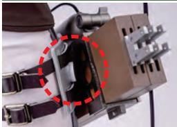
ブレードホルダーの穴を、プレートの突起にはめ込む。
